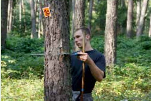
Messung des Durchmessers in 1,30 m BHD
